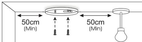
LE DÉTECTEUR DOIT ÊTRE MONTÉ AU PLAFOND À PLUS DE 50CM DES MURS ET DES OBSTRUCTIONS, IDÉALEMENT AU CENTRE DE LA PIÈCE
