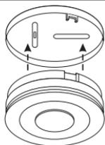
POUR LES MODÈLES DE DÉTECTEURS À PILE LITHIUM 10 ANS - LA PILE EST CONNECTÉE LORSQUE QUE LE DÉTECTEUR EST VISSE SUR LE SOCLE
