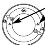
Pour le montage mural, la ligne "A" doit être horizontale et la flèche doit être pointée vers le haut.
